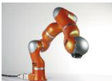
Un bras robotique industriel de nouvelle génération chez KUKA, le LightWeight Robot (LWR).
